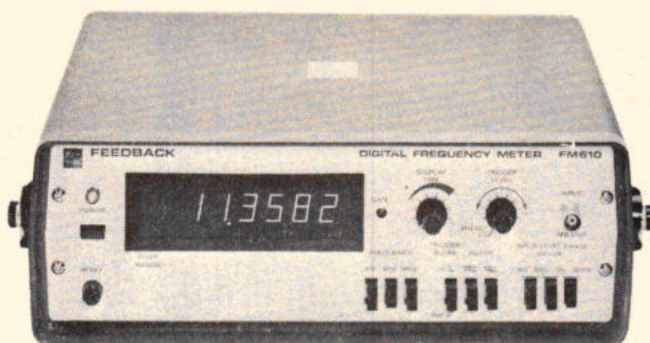
6. FM 610, digitale frequentiemeter met nauwkeurige en snelle uitlezing, ook voor lage frequenties onder 10Hz. Frequentiebereik 0,001Hz tot 10MHz. Prijs: Hfl. 1.656,-/Bfr. 24.850.
